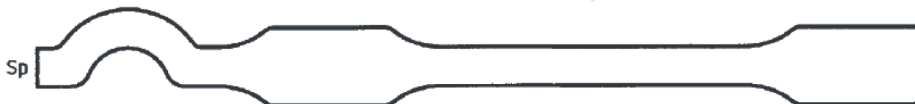
b) Carotte parallèle au plan de la surface de séparation (la courbure du canal évite les projections)
